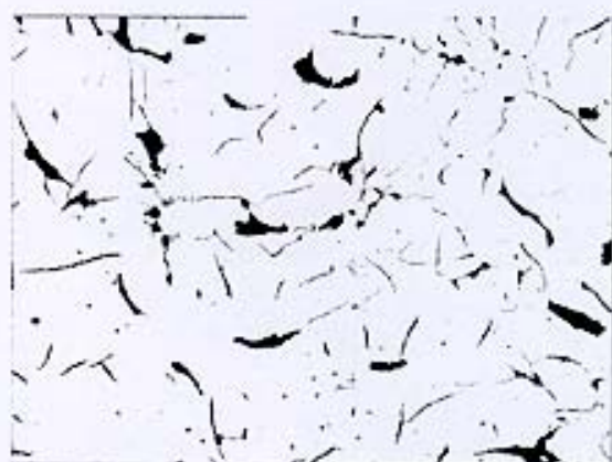
عکس ۳) توزیع، شکل و اندازه گرافیت‌های در مغز نمونه دیده می‌شود. قبل از اچ (×۱۰۰)
